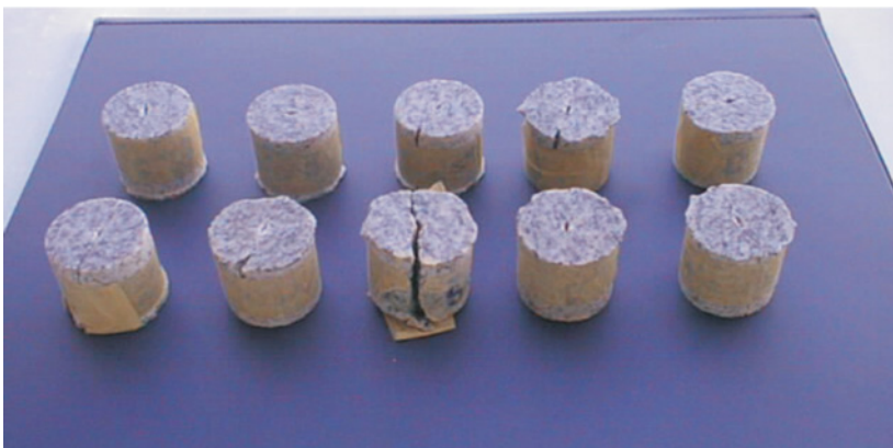
Figura 4 Corpos de prova do granito comercial ensaiado pelo método de compressão pontual.
